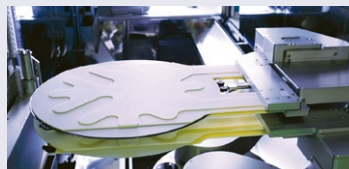
ロボットのフィンガ部分にウエハ表面をパージするアンブレラハンドを搭載
