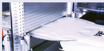
ウエハ通過部分のみを開閉するシャッター式のロードポート
