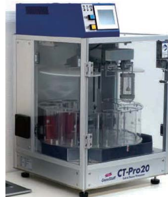
自動パラフィン包埋装置 (ローツェライフサイエンス製)
