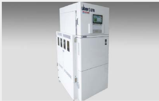
自動培地交換機能&細胞観察 機能付きCO2インキュベータ CellKeeper® II 48Plus
