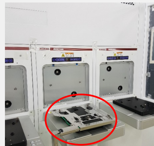
ロードポートに搭載した N2パージプレート
