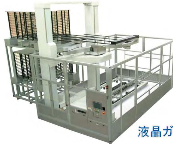
液晶ガラス基板搬送装置
