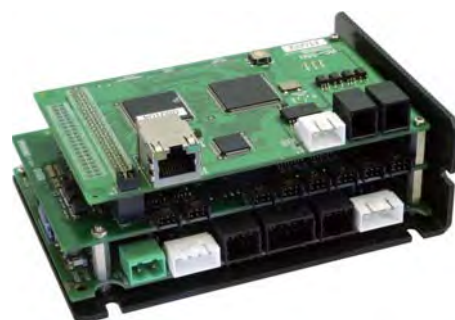
2軸脱調レスモーション コントロールドライバ RMD-S224I-G2C2
